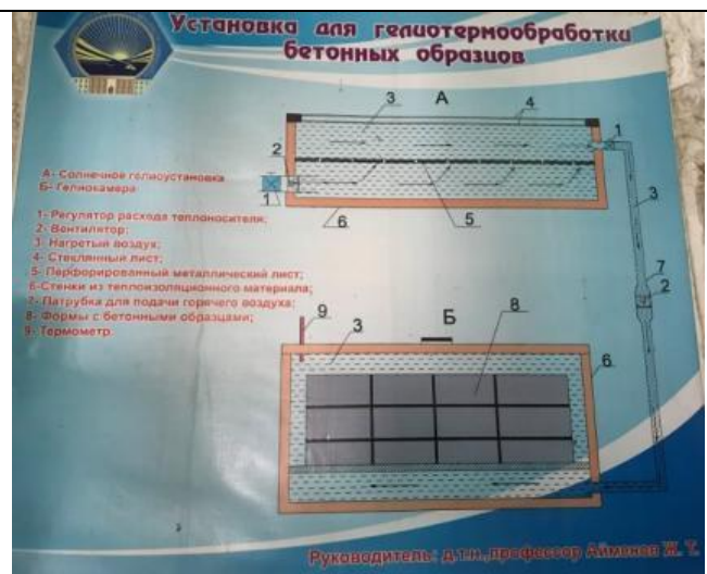
Кампус 1. Гелиокамера для аккумуляирования солнечной энергии
